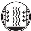
Un'idea semplice e geniale: posizionare due booster ed il generatore di vapore all'interno della camera, rispettivamente sui due lati e sul fondo. In questo modo, N1clave garantisce massime prestazioni utilizzando spazio che solitamente viene sprecato.
