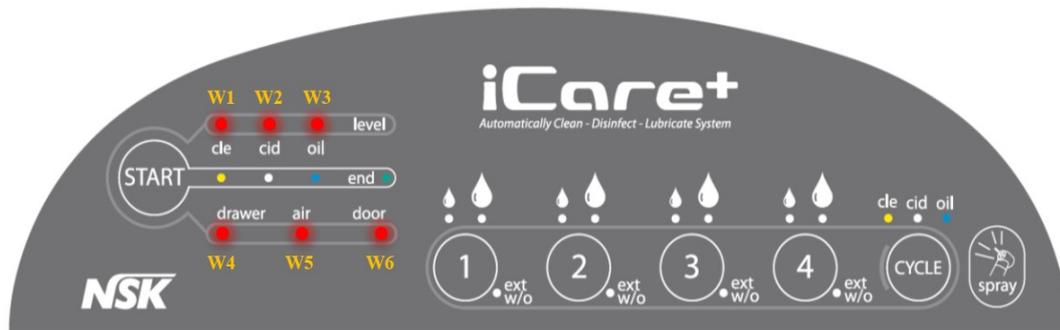
Fig. 34 - Spie di allarme e di errore
