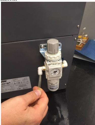
Fig. 5 - Alimentazione dell'aria
