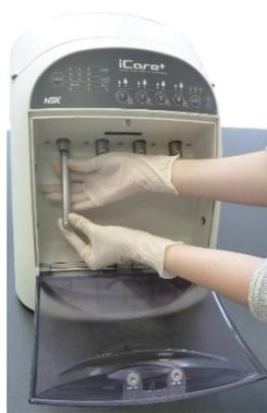
Fig. 15 - Avvitare l'anello di tenuta
