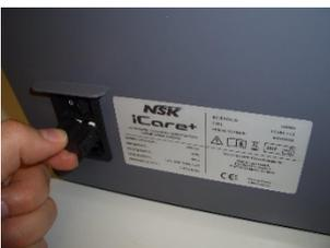
Sostituire i fusibili danneggiati.
