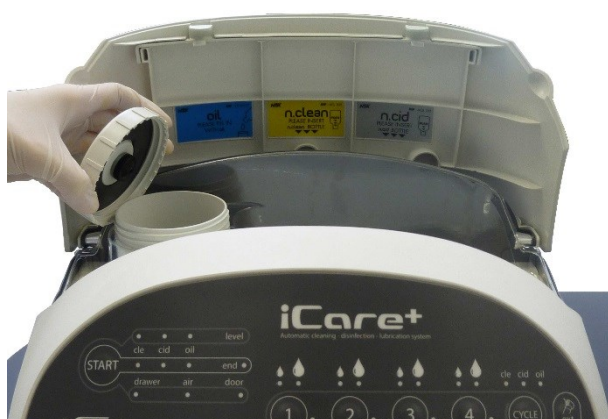
Figure 12 : Dévissage du bouchon du réservoir d'huile de l'appareil iCare+
