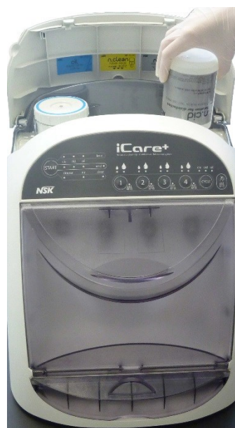
Figure 11 : Connexion de la bouteille de n.Cid (500 mL)
