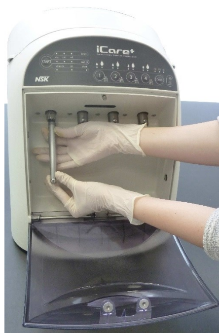
Abbildung 15: Festschrauben des Halterings am Midwest-4-Loch-Anschluss
