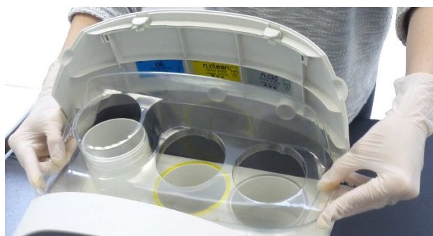
Figure 28 : Changement du blister de protection du support jonction
