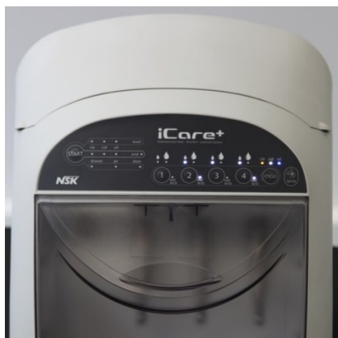
Abbildung 21: iCare+ mit aktivierten “ext/W-O”-LEDs auf den Positionen 2 und 4
