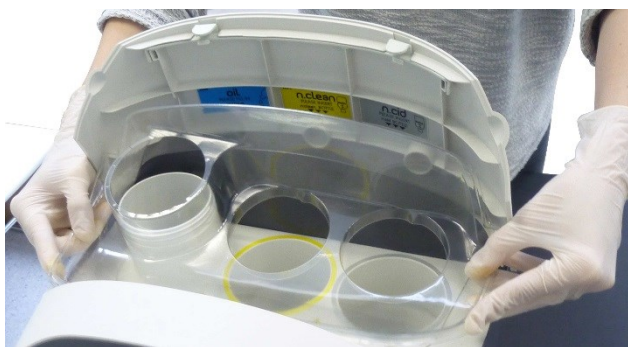
Abbildung 28: Austausch des Kunststoffschutzes
