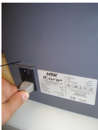
Figure 8 : Connexion de l'appareil iCare+ au réseau électrique
