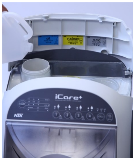
Figure 13 : Remplissage du réservoir d'huile de l'appareil iCare+
