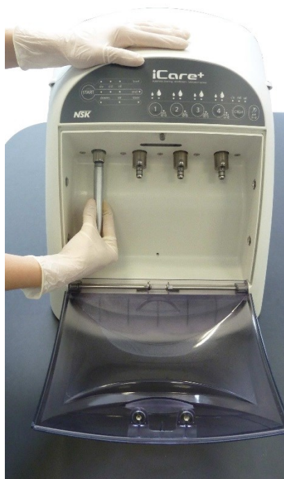
Abbildung 14: Anschluss einer Turbine (Typ Midwest 4-Loch)
