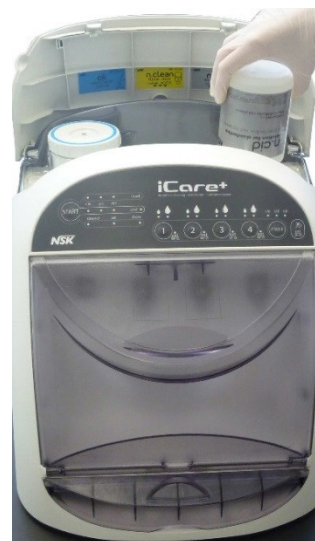
Abbildung 11: Einsetzen der n.cid Flasche (500ml)
