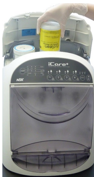
Figure 10 : Connexion de la bouteille de n.Clean (500 mL)
