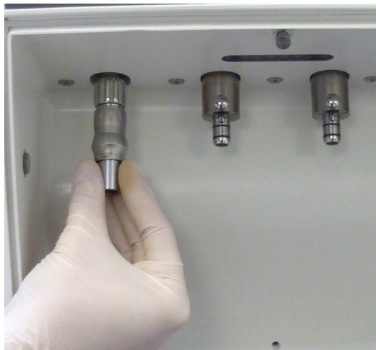
Abbildung 16: Anschluss bzw. Wechsel eines Turbinenadapters
